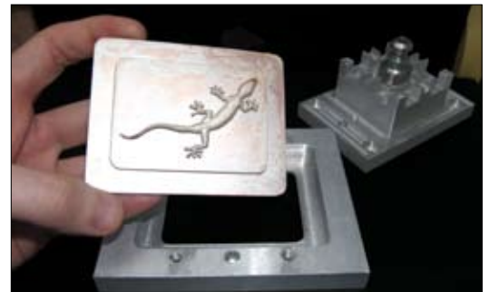
Pieza fabricada por deformación incremental de chapas.
